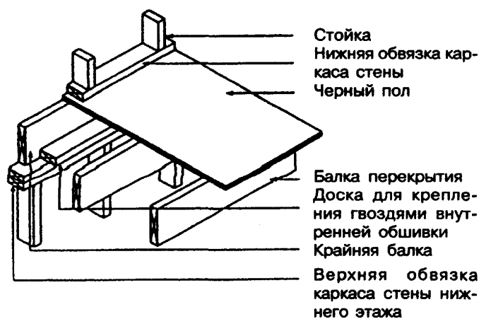
Рисунок 7-4 — Деталь установки доски для крепления внутренней обшивки
